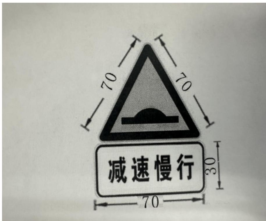
标志支撑方式建议使用单柱式，标志下缘距地面 250cm，标志内边缘距道路外侧边缘或土路肩应不少于 25cm。【道路交通标
